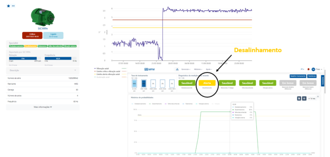
Figura 3 | Por meio da inteligência artificial (IA) e algoritmos avançados, falhas iniciais são possíveis de serem identificadas, permitindo uma intervenção antecipada da equipe de manutenção, evitando longas paradas, o que resulta em prejuízo para a produção. Com o WEG Motor Specialist, você também analisa a eficiência energética, potência de saída, carga e rotação, por exemplo.
